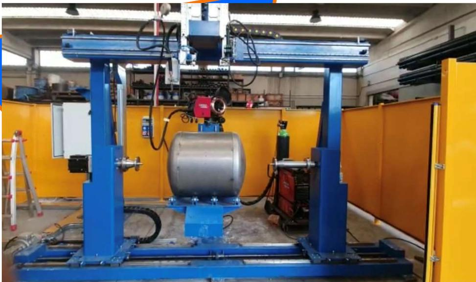
*Questo portale può essere realizzato per qualsiasi tipo di serbatoio di diametro e altezza.*
