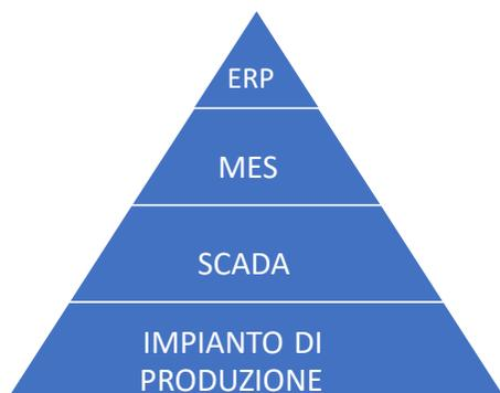
Nella architettura dei sistemi di produzione lo Scada (Supervisory Control and Data Acquisition) è la base della raccolta dati e controllo dell'impianto di produzione industriale, il passaggio dei dati verso l'ERP (Enterprise Resource Plannig) avviene solitamente attraverso il MES (Manufacturing Execution System) che è un sistema informatizzato per la gestione della produzione.
